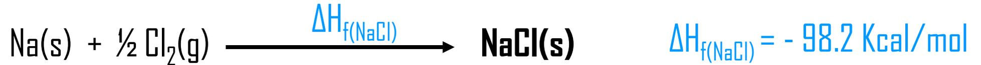
L'énergie libérée par la réaction est l'enthalpie de formation du solide ( $\Delta H_{\text{f}}$ ). Elle est facile à mesurer et peut être calculée à partir des tables thermodynamiques. On peut décomposer cette transformation en plusieurs étapes : sublimation et ionisation du sodium, dissociation de la molécule de chlore et formation de l'ion  $\text{Cl}^-(\text{g})$ . A chacune de ces réactions correspond une énergie spécifique.
